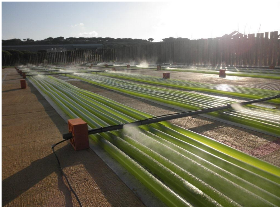
Figuur 10. Grootschalige testopstelling voor productie van algen in Spanje door Wageningen University (Foto: Prof. R. Wijffels).
